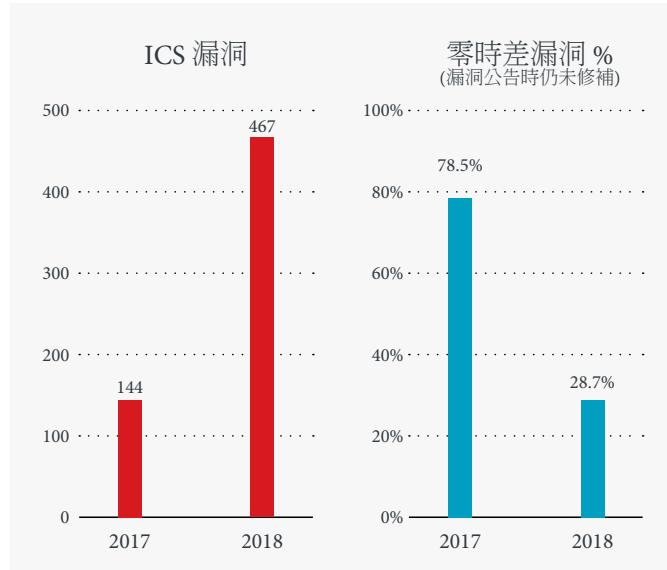
圖 20：ICS 漏洞數量逐年比較：儘管 ICS 的漏洞數量增加，但漏洞公告時仍未完成修補的比例卻降低。
