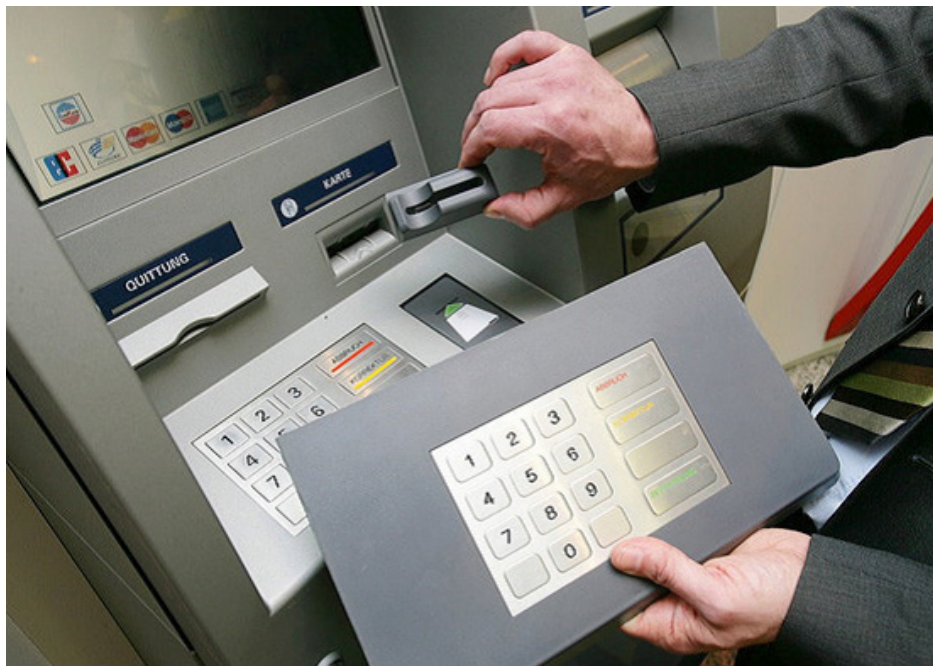
圖 3：舊式使用硬體設備來盜拷卡片磁條資料的攻擊方法 8 。
